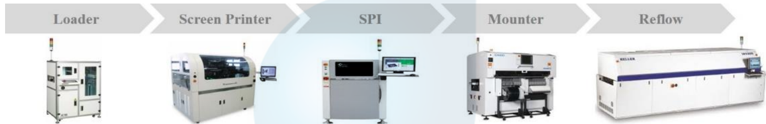
[그림 2.23] 표면 실장 기술 공정을 구성하는 설비의 종류
